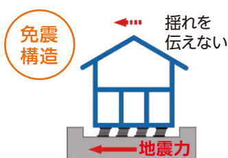
図1 免震構造と耐震構造の違い
