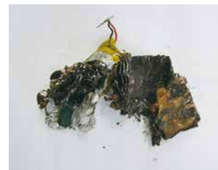
火災の原因となったリチウムイオン電池の燃えかす
