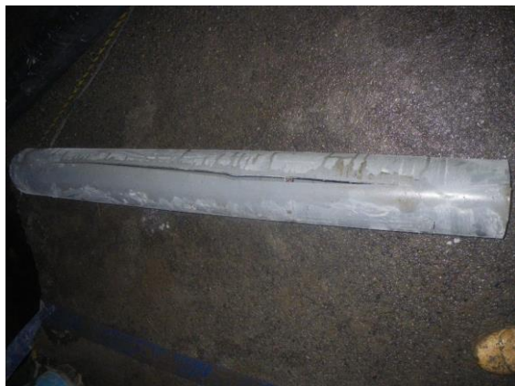
破断した塩化ビニル管の取り替え（波賀町上野）
