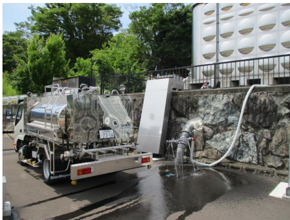
応急給水栓と給水車
