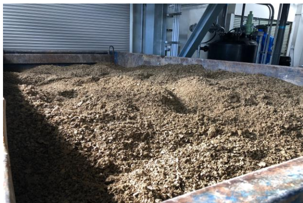
浄水処理で排出された汚泥
