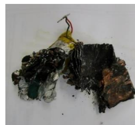
（写真 消火後のリチウムイオン電池）
