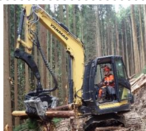
【写真2】枝払い・玉切りを担う機械です。林道や土場などで、全木集材されてきた材の枝払い、測尺、玉切りを連続して行います。
