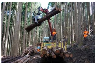
【写真3】集材を担う機械です。玉切りした短幹材をグラップルクレーンで荷台に積んで運ぶ集材専用のものです。
